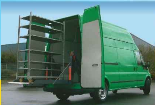
Durch d. Linear-Ladelift, der in den Kastenwagen eingebaut wird, können CC-Container u. Paletten bequem be- und entladen werden
