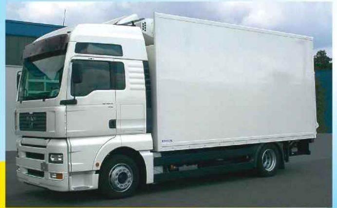
Isolieraufbau für den Blumentransport zum Im- und Export geeignet, mit Kühl- und Heizungsanlage
