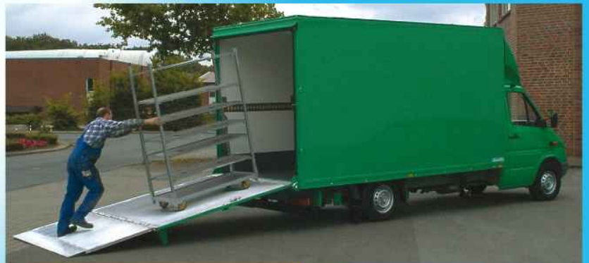
Flora Express auf Basis MB Sprinter, Radstand 4025 mm mit Vollluftfederung auf der Hinterachse, Isolieraufbau, Standheizung, kompl. Heckrampe. Hinweis: durch die Luftfederung kann das Fahrzeug zur optimalen Beladungshöhe abgesenkt werden. Passend für 9 CC-Container.
