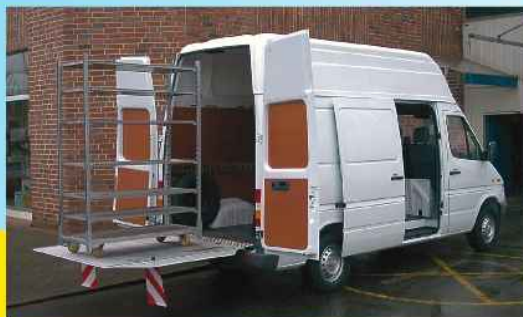
Blumen Express a. Basis MB Sprinter Kastenwagen mit außenliegender Ladebordwand. Vorteil: breite Ladeplattform f. 2 CC-Container, kein Platzverlust im Fahrzeug
