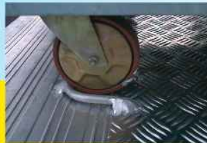
Spez. Abrollsicherung auf der Ladebordwand für CC-Container
