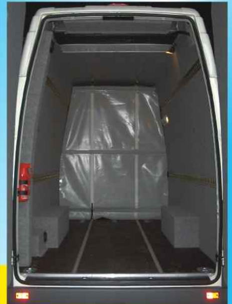
Verstellbare Trennwand, dient zur unterschiedlichen Wärmedämmung im Kastenwagen mit Evels-Hochdach
