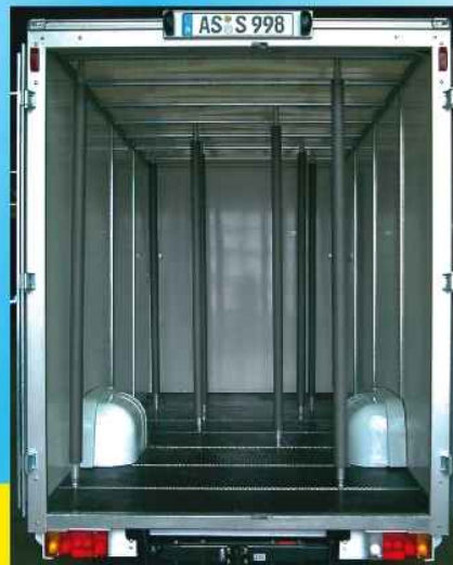
Senkrechte Sperrbalken zur Ladungssicherung von z.B. Fenstern
