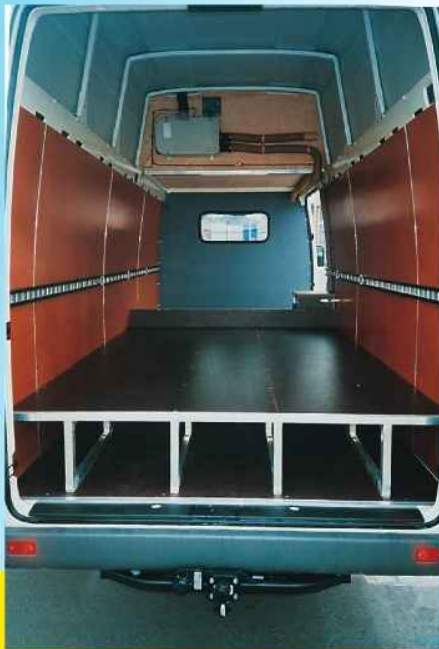
Durchgehende Ladefläche, Schlafplatz im Hochdach, Standheizung, Innenverkleidung mit Zurrleisten.
