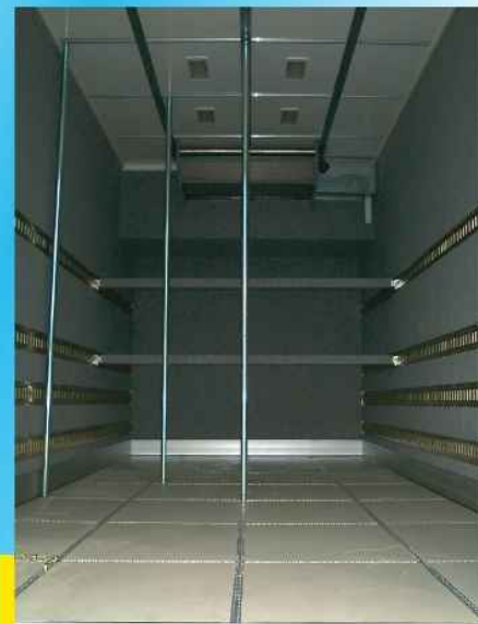
Zurrsystem zur waagerechten und senkrechten Ladungssicherung
