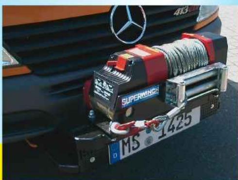
Seilwinde am vorderen Stoßfänger für den kommunalen Bereich
