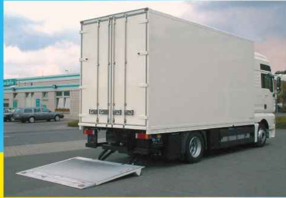
Standard Ladebordwand - 1500 kg - hinter den Hecktüren angeschlagen
