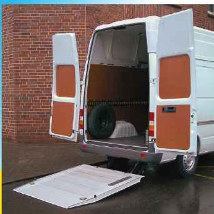
Ladebordwand beim Kastenwagen zur Beladung von Gütern auf Paletten, Rollcontainern usw.
