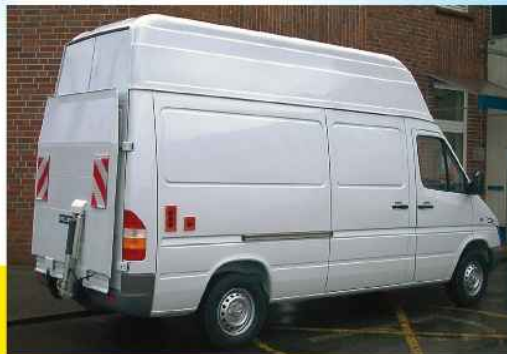
Ladebordwand 500 kg Tragkraft, beim Kastenwagen hinter die Hecktüren geklappt
