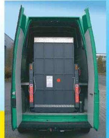
Linear-Ladelift in den Kastenwagen eingeklappt
