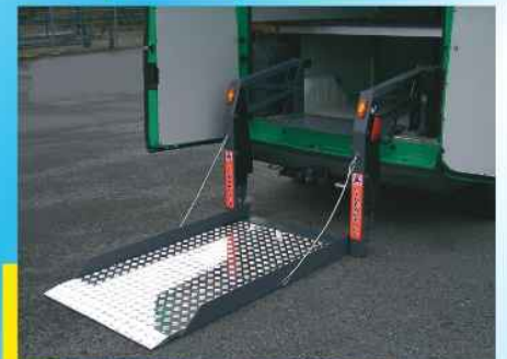
Linear-Ladelift eingebaut in einem Kastenwagen
