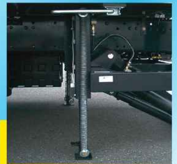
Hydraulische Abstützung in Verbindung m. einer Ladebordwand
