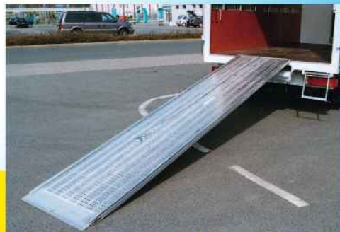
Die Alu-Auffahrrampe wird platzsparend unter den Kofferaufbau eingeschoben
