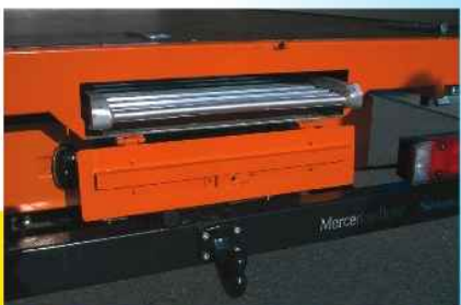
Unterschiebbare Laderampe im eingeschobenen Zustand
