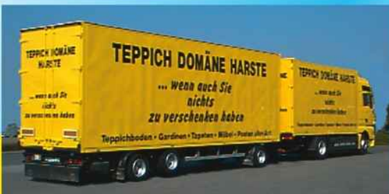
18-Tonner 3Achsen-Anhänger mit Kurzkuppelsystem und Nietbaukoffer
