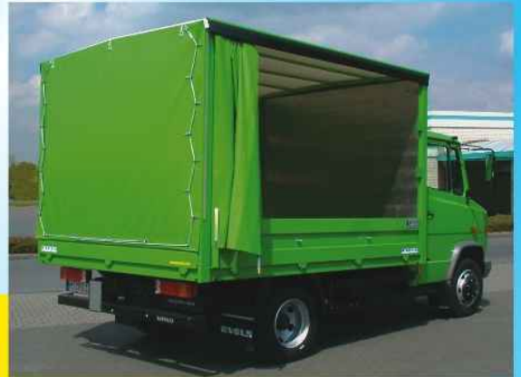
Pritsche mit seittl. Schiebeplane. Besonders praktisch für die seittl. Be- und Entladung
