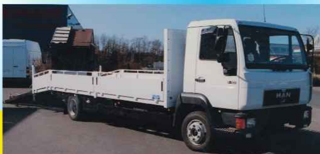
Tiefladepritsche mit hydraulischer Laderampe für den Transport von Rasenmähern und Kehrmaschinen
