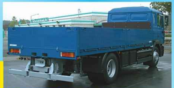
Schwerlastpritsche für Gasflaschentransport mit Unterfahrschutz für Mitnahmestapler
