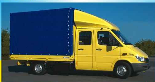
Pritsche mit Plane/Spriegel auf MB Sprinter Doka
