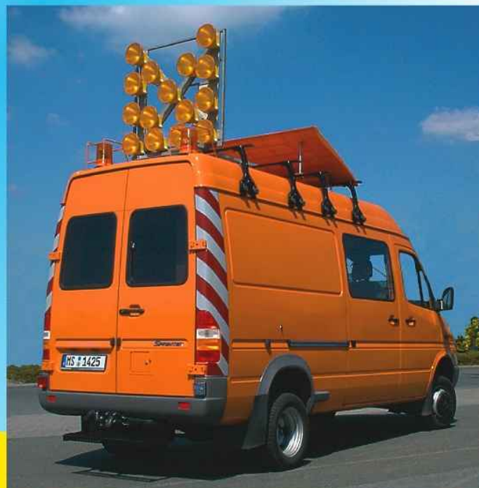
Kastenwagen mit Innenausbau zum Messfahrzeug und dachseitigem Warnkreuz
