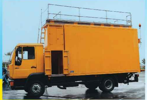
Fahrzeug zur Brückensanierung
