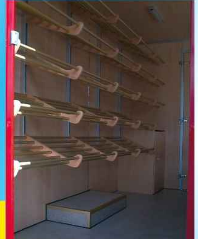
Brotrost im Kofferaufbau montiert
